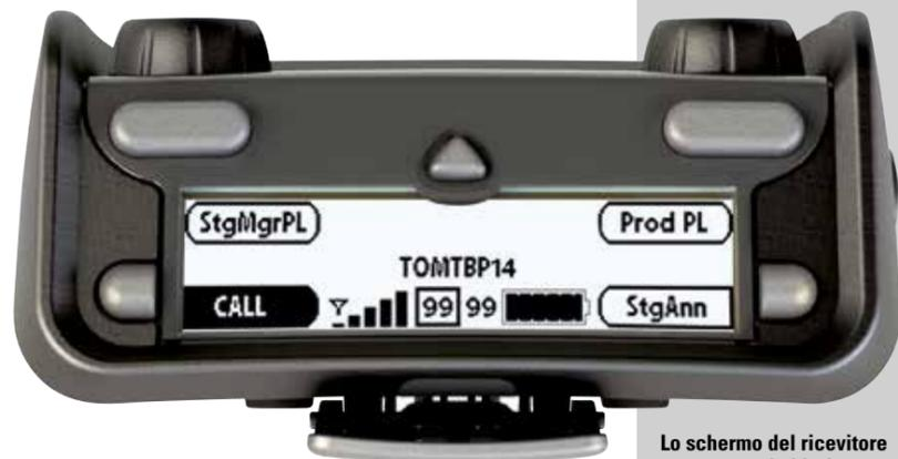
Lo schermo del ricevitore con caratteri chiari, ne consentono l'uso e la lettura delle informazioni, in modo pratico e veloce. A seguire, uno dei modelli delle robuste cuffie previste a corredo con il sistema della Pliant. Infine, il retro del pannello relativo al modello a quattro canali, con evidenza di tutti i connettori razionalmente distribuiti.
