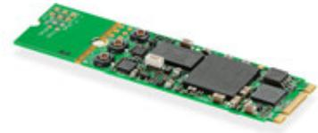
Scheda M.2 miniaturizzata con connessioni 3G-SDI per acquisizione e riproduzione simultanee in tutti i formati fino al 1080p60. DeckLink SDI Micro inoltre include un ingresso di riferimento black burst e tri-sync, e grazie al suo design ultra compatto, è ideale per l'uso con soluzioni portatili che utilizzano computer di piccole dimensioni!
