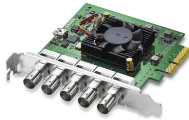
Dotata di 4 connessioni 3G-SDI indipendenti, DeckLink Duo 2 è una scheda PCI Express di cattura e riproduzione compatibile con i formati SD e HD fino al 1080p60. Scopri la flessibilità di 4 schede di cattura e riproduzione in una! Completamente personalizzabile, è la soluzione ideale per i sistemi di riproduzione multimediale, i server per la pubblicità digitale multischermo, i dispositivi di cattura multicanale in tempo reale e non solo.
