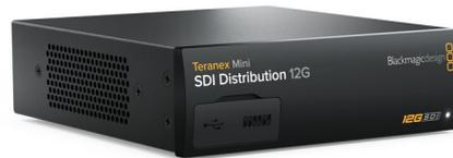
Questo modello distribuisce un singolo segnale SDI di entrata fino a otto uscite SDI. Vanta connessioni multifrequenza 12G-SDI con reclocking SDI, garantendo la commutazione automatica tra tutti i formati in SD, HD e Ultra HD fino a 2160p60. È perfetto per distribuire un singolo segnale SDI a più dispositivi tra cui monitor, switcher e codificatori.
